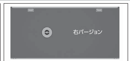
図3: ドレン管接続位置 右バージョン
