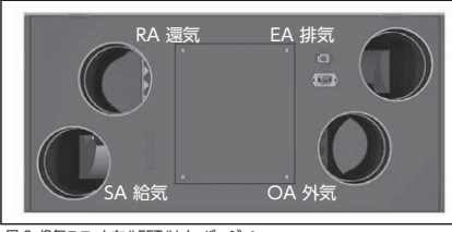
図2: 換気ユニット左/LEFT/linkeバージョン
