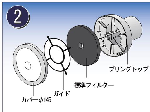
カバーを左に回して外し、押え部品のガイドを外すとフィルターが取り出せます。
